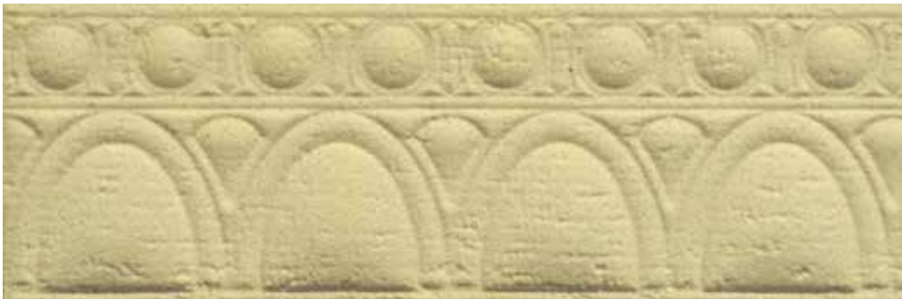
Resim 2. Dursunbey Kilinin 1200°C Sıcaklıktaki Sırsız Pişme Rengi
