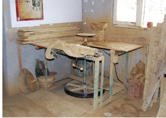
Resim 17: Bilecik İli, Kınık Köyünde Kullanılan Elektrikli Torna, Salim Yaşar Atölyesi.
