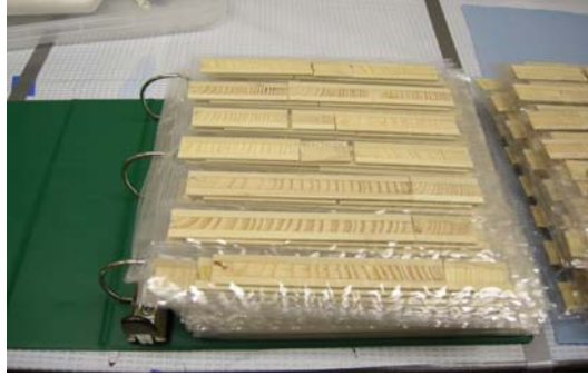
Şekil 2. Plastik koruyucular içerisine yerleştirilmiş ve X-ray ölçümüne hazır örnekler
