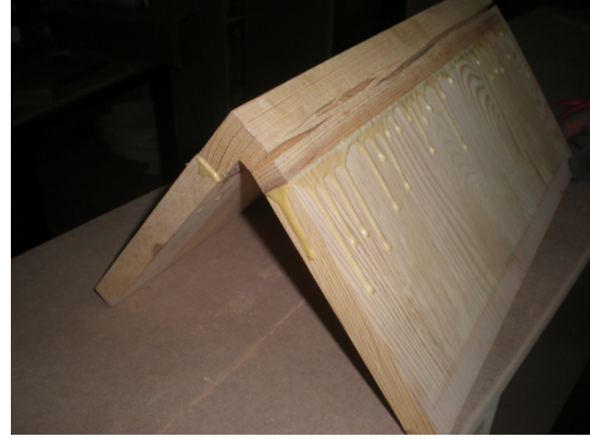
Şekil 4. L-köşe elemanlı deney örnekleri deney sonrası fotoğraflar
