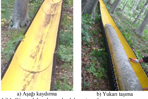
Şekil 1. Güzergah kurulumunda oluk pozisyonları
