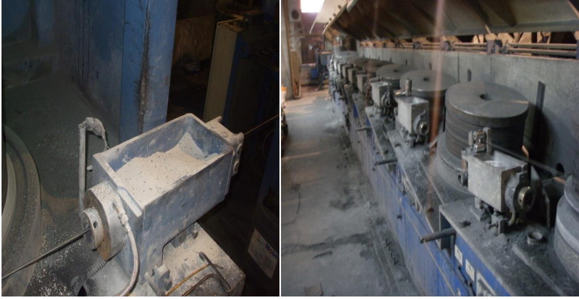
Şekil 1. Tel çekme prosesi ve üretim hattı
