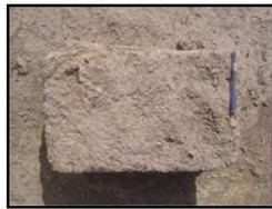
Foto 3. Kümbet Evlerde Genel Olarak Tercih Edilen 30x50x10 Ebadındaki Kerpiçler.
