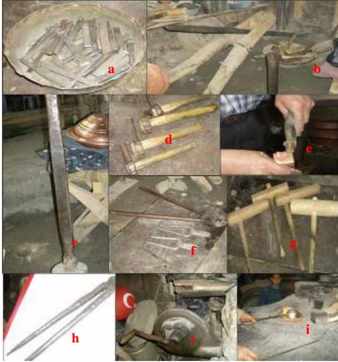
Şekil 1. Bakırcılıkta kullanılan el araçları (a. Kalemler, b. Nay eşeği, c. Endirek, d. Ablasım e. Diş makası, f. tel makası, g. Tokmaklar, h. Pergel, i. Körük, i. Ocak)
