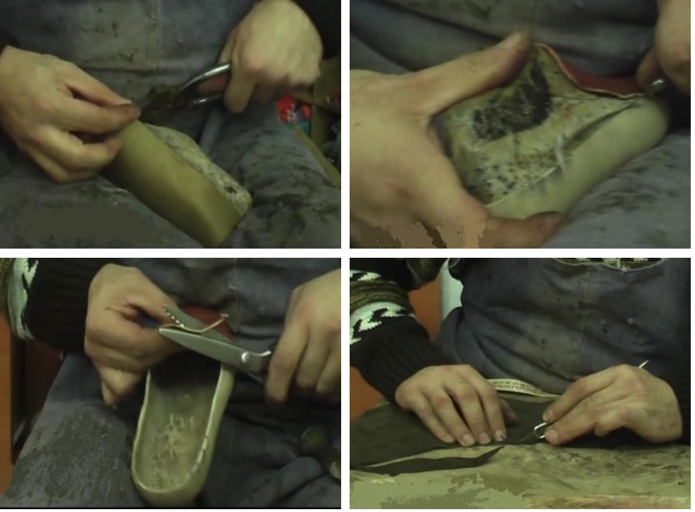
Şekil 5 . Kalıpta şekil almış ayakkabının fazlalıklarının kesilmesi
