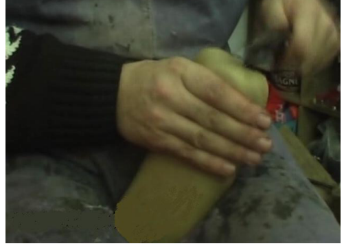
Şekil 4. Çarığın kalıba gerilmesi
