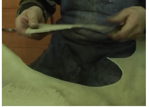
Şekil 2. Ayakkabı kalıbının deri üzerine yerleştirilip bıçak ile kesilmesi
