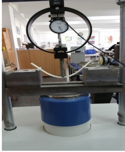
Şekil 3. Kompozit numuneye eğme deneyinin uygulanışı
