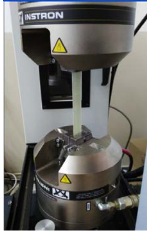
Şekil 2. Kompozitin elastisite modülünün belirlenmesi
