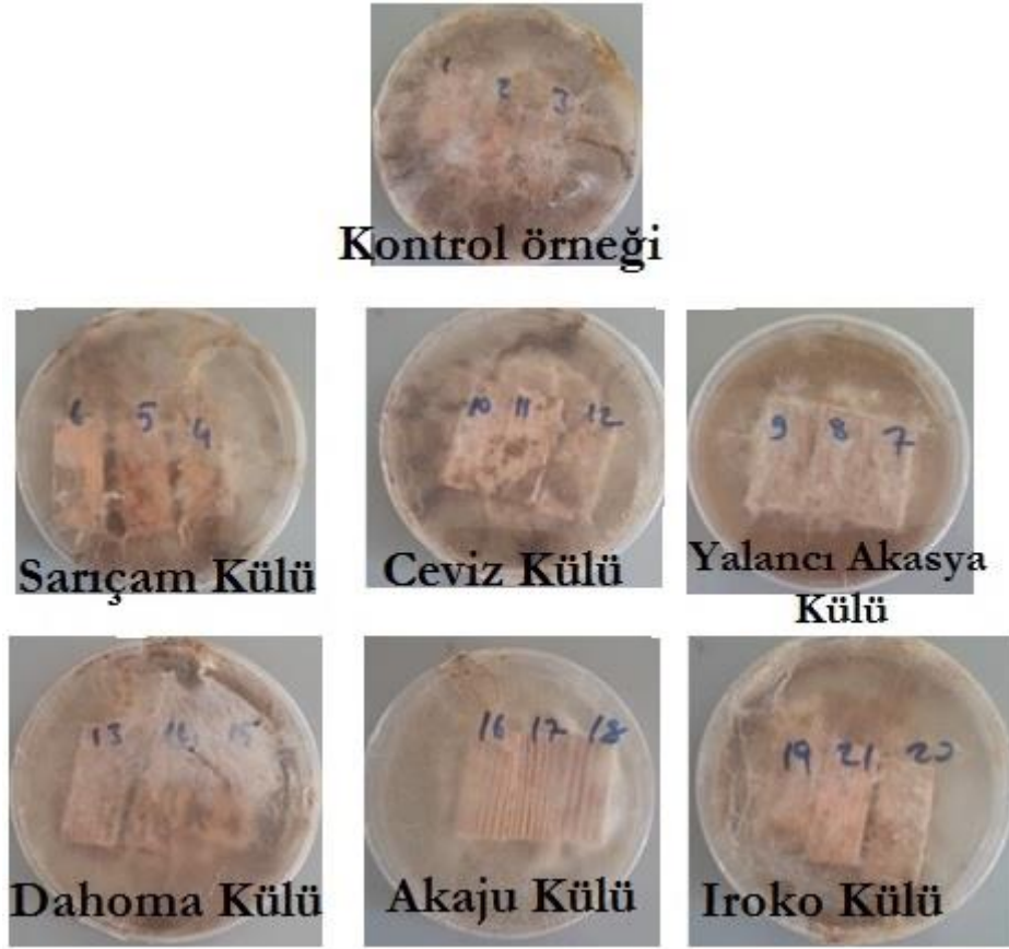
Şekil 2. Coniophora puteana mantarına maruz bırakılan sarıçam örneklerinin 12 hafta sonundaki görünümü
