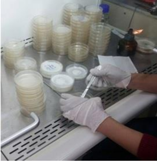
Şekil 1. Mantar besi ortamının steril ortamda hazırlanması ve emprenyeli örneklerin mantara yatırılması
