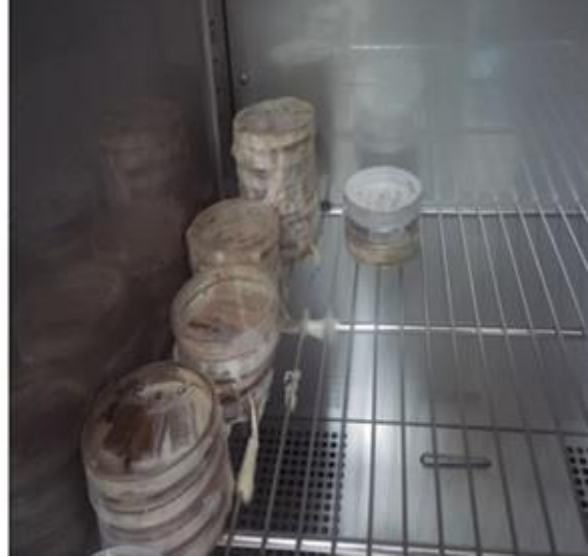
Şekil 1. Mantar besi ortamının steril ortamda hazırlanması ve emprenyeli örneklerin mantara yatırılması
