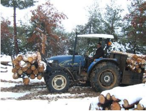
Şekil 6. Tarım traktörüne monte edilen seleler yardımıyla bölmeden çıkarma yöntemi
