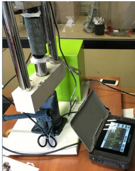
Şekil 4. Proseq UPV test cihazı ve silindirik korotların UPV ölçümü Figure 4. Proseq UPV test instrument and measurement of UPV of cylindrical core specimens
