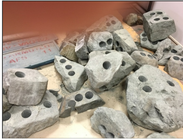
Şekil 2. Kayalık bloklarından silindirik karot örnekleri çıkartılması Figure 2. The acquisition of cylindrical core specimens from rock blocks
