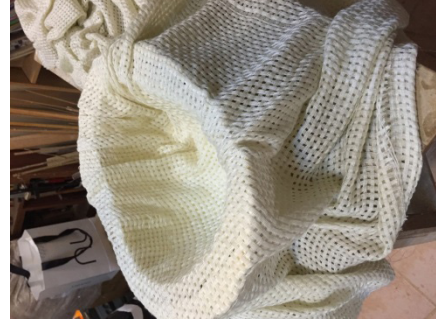
Resim 16. Kumaşın sertleştirilme aşaması
