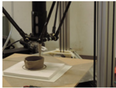
Görsel 17-18. Üç Boyutlu Yazıcı üretim aşaması
