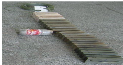
Şekil 1. Emprenyeli ve kontrol sarıçam odun numunelerinin deney alanlarına yerleştirilmeden önce dizildikleri düzeneğin görüntüsü
