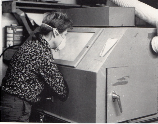
Görsel 2. Kumlama Makinası, Littleton Atölyesinden
