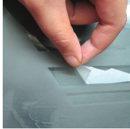
Görsel 3. Kumlama folyosu kullanılarak kumlanmış cam kalıp, Fotoğraf. E.Feyza Ulu. Aaanadolu Üniv. 2009
