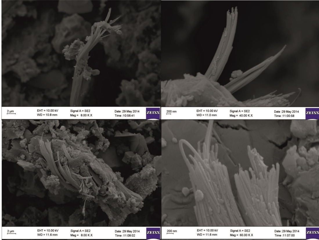
Şekil 3. Fren balatalarındaki asbest liflerinin FE-SEM görüntüleri
