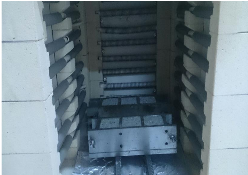
Şekil 5. Fırına yerleştirilmiş numuneler
