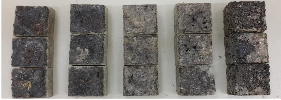
Şekil 6. Kıl pestili agregalı numuneler (soldan sağa kontrol, % 20, 40, 60 ve 80 oranlı)
