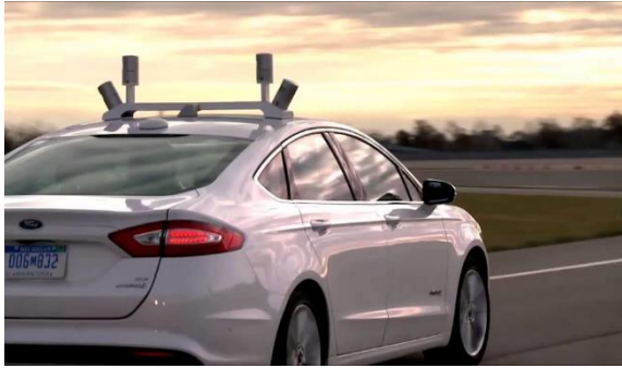
Şekil-8: Ford Focus Lidar İnsansız Aracı.
