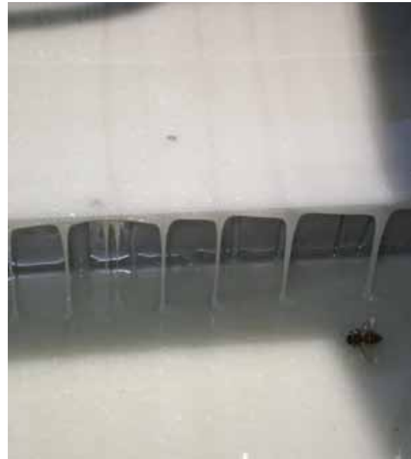
Resim 2. Nem alma panelinde balın kütle transferinin gerçekleşmesi.
