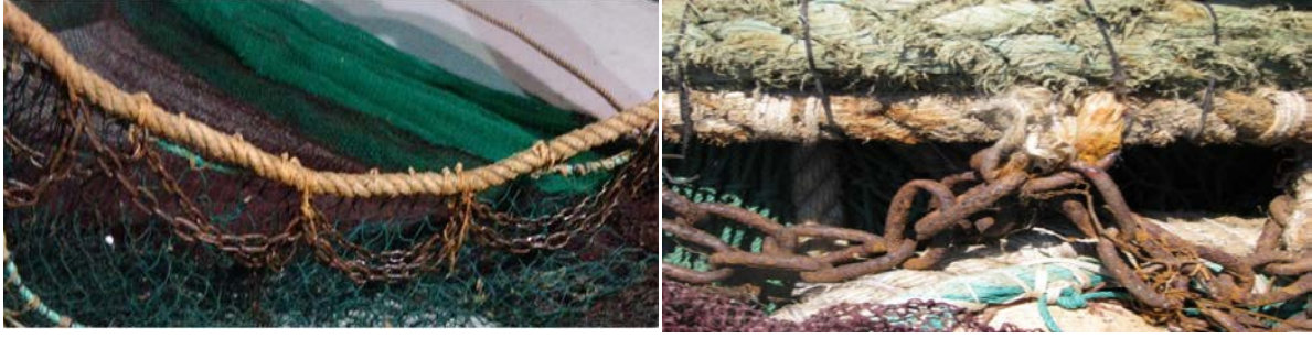
Şekil 1. Dip trol ağında iki farklı kurşun yaka modeli (Zengin vd., 2014a).
