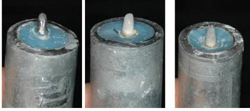
Şekil 2. Paslanmaz çelik kalıplara yerleştirilmiş test örnekleri
