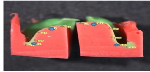
Şekil 3. Replikanın mezyo-distal yönde yapılan kesitinde iç yüzey aralık değerlendirme için ölçümü yapılan noktalar.
