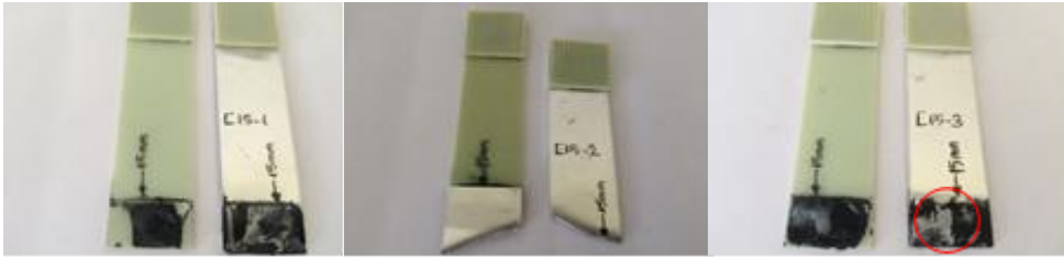
Şekil 14. Kesme deneyi sonrası C15 numuneleri
