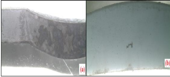
Şekil 5. a) WL-2 numunesine ait makroyapı fotoğrafı (30x) dağlanmış, b) WT-3 numunesine ait makroyapı fotoğrafı (30x) parlatılmış
