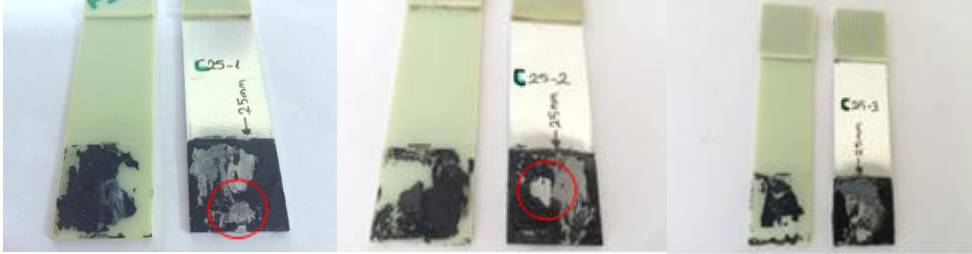
Şekil 18. Kesme deneyi sonrası C25 numuneleri
