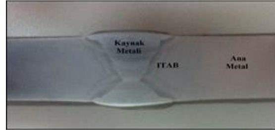
Şekil 2. X65 malzeme makroyapı fotoğrafı
