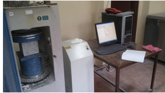
Şekil 6. Beton presi aleti ile beton örneği üzerinde yapılan dayanım deneyi aşaması
