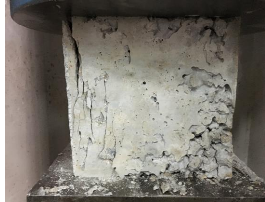
Şekil 4. 6 no'lu karışımla hazırlanmış küp numune kırılma şekli
