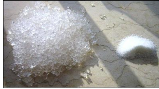
Şekil 10. Süper emici polimerlerin ıslanma öncesi ve sonrası görünümü [8]
