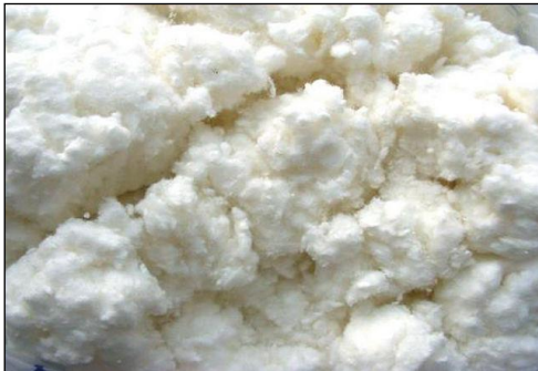
Şekil 9. Selülozik tabakayı oluşturan lifler [7]
