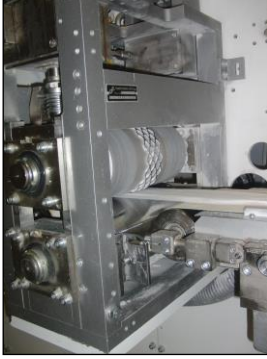
Şekil 23. Sıvı kanalı oluşturan baskı silindiri
