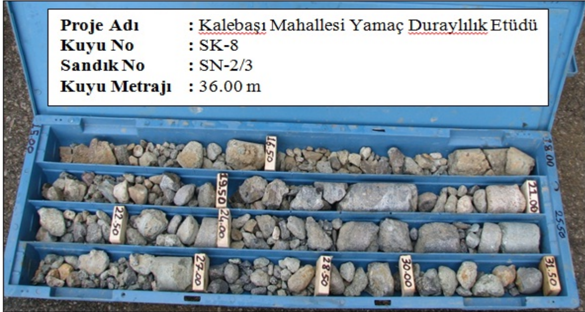
Şekil 5. İnceleme alanında yapılan araştırma sondajı kuyusundan alınan numunelerin görünümü. Figure 5. The view of samples taken from borehole in the field.
