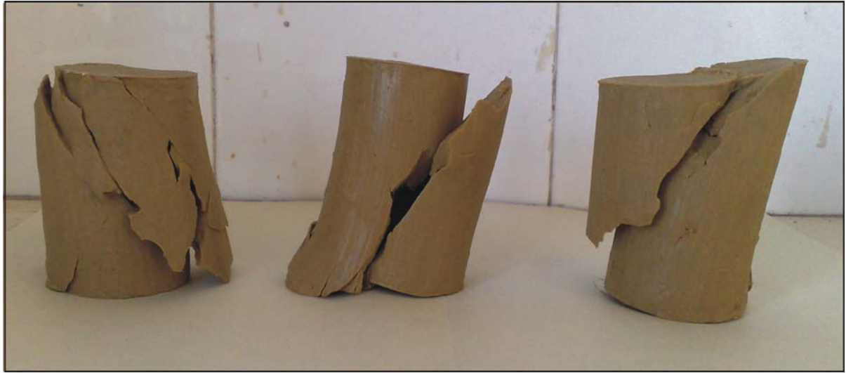
Şekil 10. Serbest basınç deneyi gerçekleştirilen üç numune.
