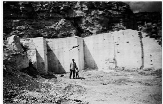
Şekil 9. Tel kesme yöntemiyle kısmen işletilmiş tabaka tipi travertenlerden görünüm (Soğuk Çermik-Sivas) Figure 9. A view of the layered type travertines partly operated by fibre method (Soğuk Çermik-Sivas)
