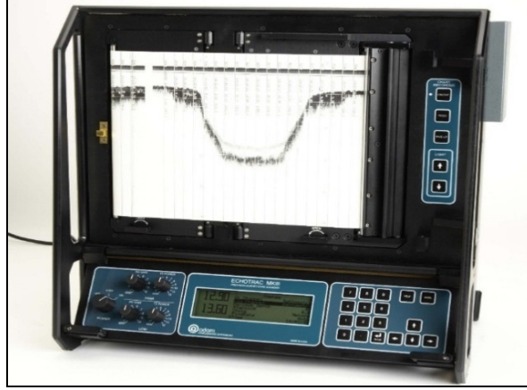
Şekil 7. ODOM Echotrac 3200 MKII Echosounder
