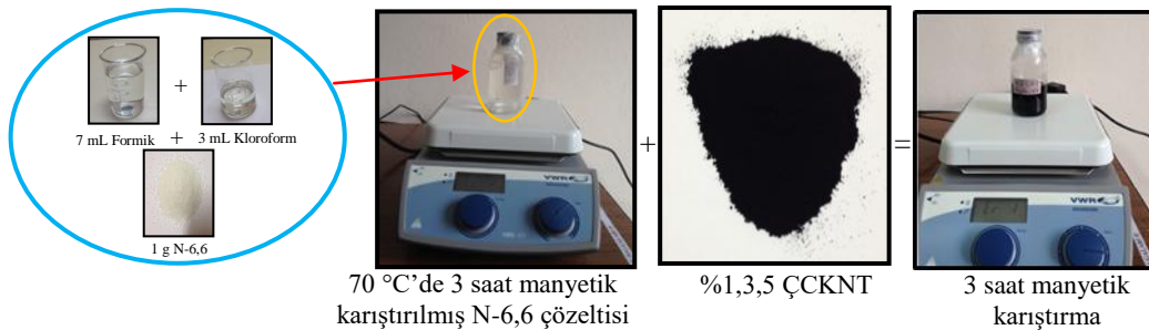
Şekil 2.4. % 1,3,5 ÇCKNT ile güçlendirilmiş N-6,6 çözeltisinin hazırlanması
