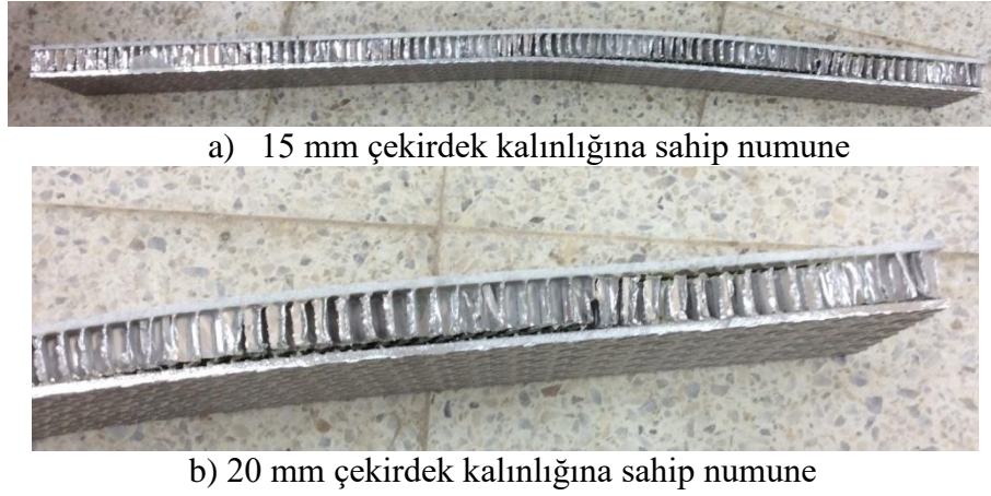
Şekil 10. Eğilme deneyi sonrasında numunelerde oluşan hasar durumu
