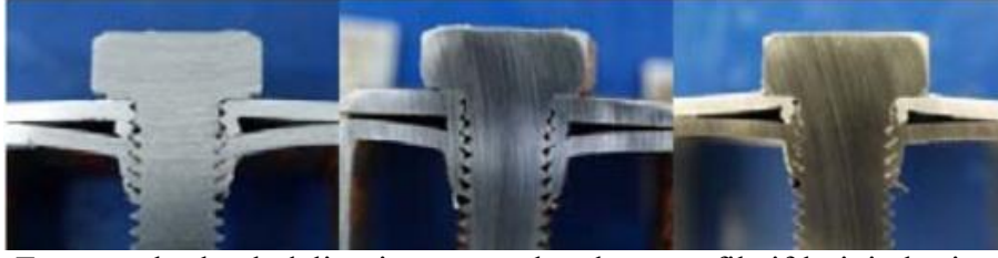
Şekil 8. Eş zamanlı olarak delinmiş sac metal ve kutu profil çiftlerinin kesit görünüşü
