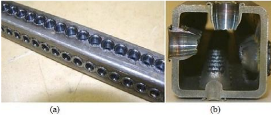
Şekil 6. Sürtünlü matkap ile delinmiş AISI 1015 profil a) İzometrik görünüş b) Kesit görünüşü
