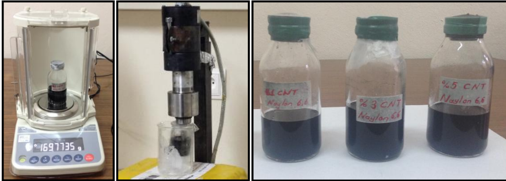
Şekil 2.5. %1,3,5 ÇCKNT ile güçlendirilmiş n-6,6 çözeltisinin problu ultrasonik homojenizatör ile karıştırılması
