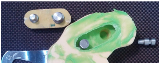
Resim 1. Üretilen silikon kalıpların güdükler yerleştirildikten sonraki görüntüsü
