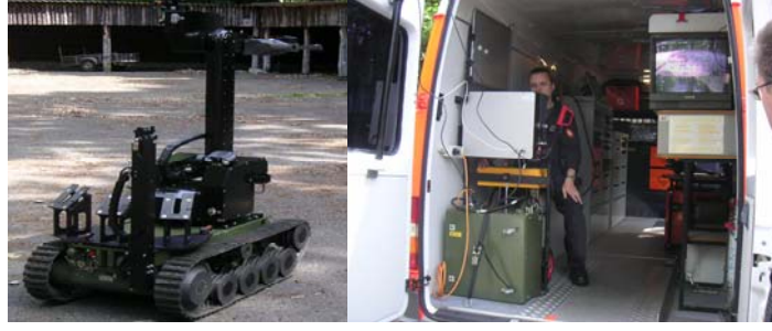
Şekil 1. Uzaktan kontrol edilen bir robot ve kumanda paneli [11].
