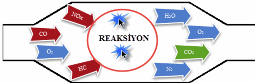
Şekil 1. Üç yollu konvertörlerde gerçekleşen kimyasal reaksiyonlar
