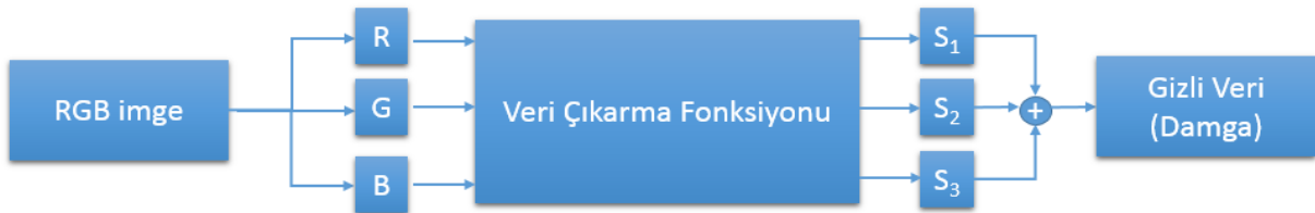
Şekil 4. Önerilen veri çıkarma algoritmasının blok diyagramı.
