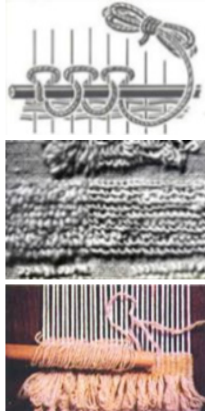
Resim 14. Çubuklu ilmek dolama örnekleri.
