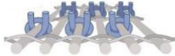
Resim 9. İspanyol düğümünün şematik gösterimi.
