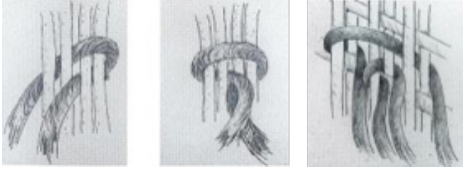
Resim 7. a) Asimetrik, b) simetrik, c) 6 çözümlü çift düğümleri.
