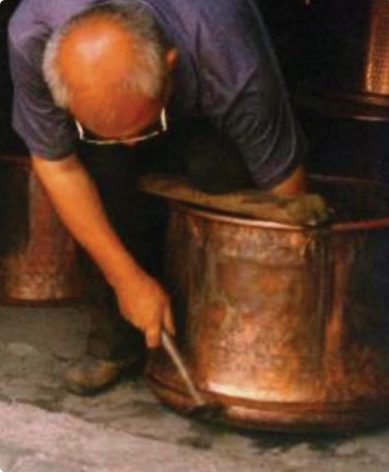
Resim 53. “Bakır kaynağı” (“kaynak”, “katı lehim”, “diş açarak birleştirme” ve “dişli perçin”) birleştirme safhalarının üçüncüsü; “tabanın geçirilmesi” (Dursun 2014: 818).
