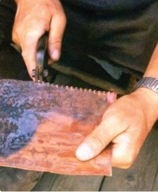
Resim 51. “Bakır kaynağı” (“kaynak”, “katı lehim”, “diş açarak birleştirme” ve “dişli perçin”) birleştirme safhalarının ilki; “çentik” (diş) açma (Dursun, 2014: 817).
