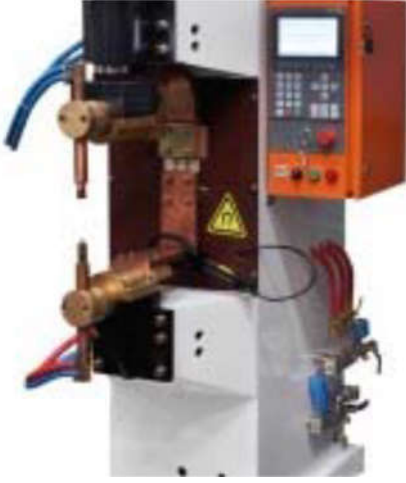
Şekil 2. Elektrik direnç kaynağı makinesi.(Electrical resistance welding machine)
