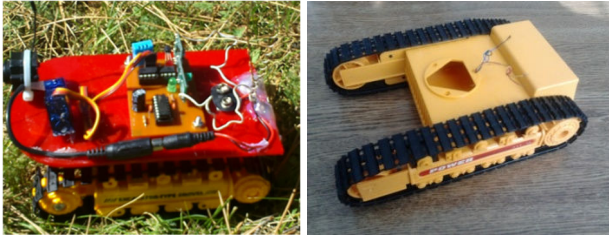
Şekil 7. Palet hareket sistemi (Pallet movement system)
