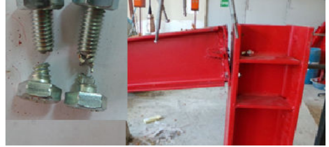
Şekil 9a. E160 birleşimi için göçme şekilleri (Failure modes for E160 connection)
