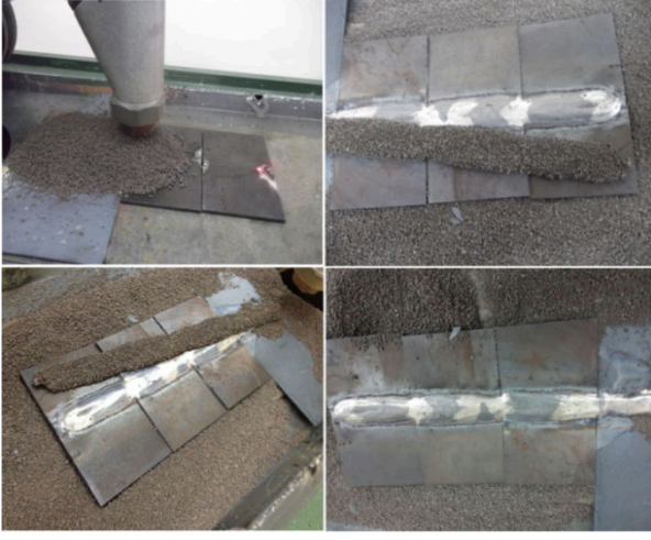
Şekil 1. Ramor 500 malzeme çiftlerinin tozaltı kaynağı sırasındaki resimleri (Images of Ramor 500 material pairs on the side of the underwater source)
