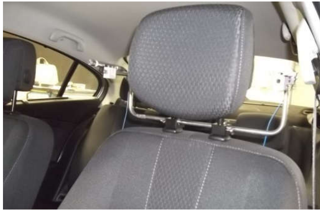
Şekil 2. Kaynak-iletim yolu-alıcı testi: (a) testin görsel örneklemesi (b) egzoz bağlantısı (c) mikrofonun konumu (Source-path-receiver test (a) demonstration of the test (b) exhaust mount (c) location of the microphone)
