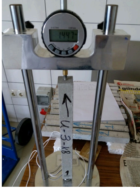
Şekil 1. Harç karışımlarının kuruma-büzülme ölçümü (Drying-shrinkage measurement of mortar mixture)
