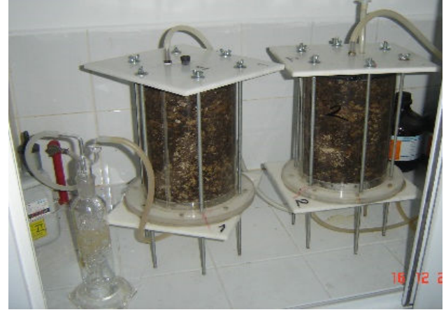
Şekil 1. Seri bağlı reaktör sistemi ve besleme düzeni (Reaktors connected in series and loading layout)
