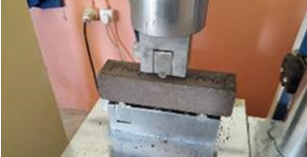
Şekil 2. Basınç ve Eğilme deneylerinin yapılması (Performing Compressive and Flexural tests)
