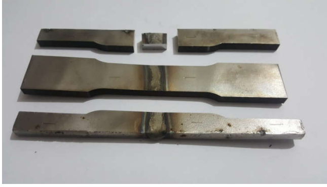
Şekil 3. Kaynaklı numunelerin tel erezyon kesimi sonrası
