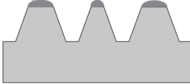
Şekil 1. İndirilmiş Flekso Baskı Kalıbı (Mürekkep alan kısımlar koyu olarak gösterilmiştir)
