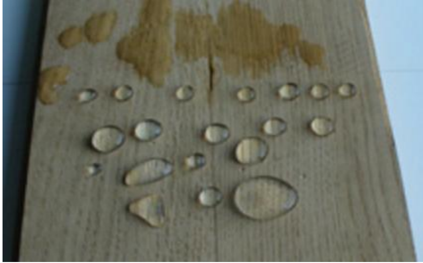
Şekil 5. Su Bazlı Nano Silan Uygulanmış Yüzey ve Uygulanamamış Yüzey (www.nanoprotect.co.uk).
