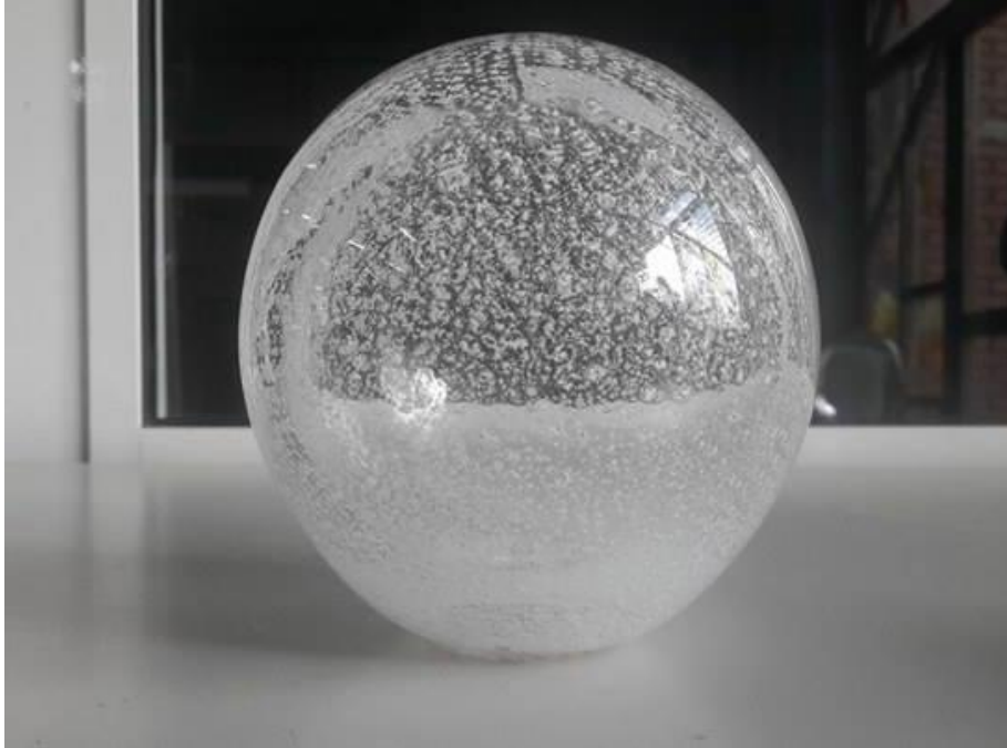
Şekil 6. İnce öğütülmüş kemik tozlarının yüzeyde kullanılması ile elde edilen cam küre.
