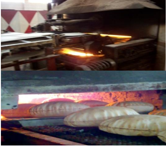
Şekil 1. Ekmeklerin fırına girişi ve çıkışı Figure 1. Entrance and exit of breads in the oven
