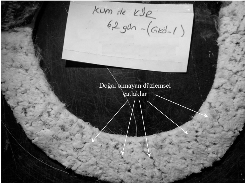
Şekil 12. Sıkıştırılmış siltli kum üzerinde tek büyük örnekli yöntem (TBÖY) ile 62 gün hidrasyon sonunda GKÖ’de açığa çıkarılan bentonitin durumu
