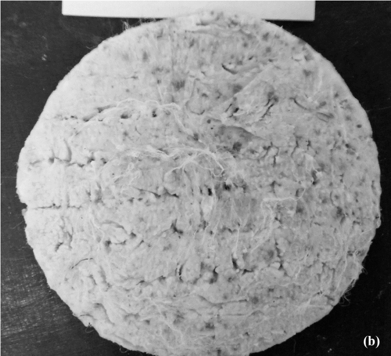
Şekil 14. Sıkıştırılmış siltli kum üzerinde 62 gün hidrasyon sonunda GKÖ'de açığa çıkarılan bentonitin durumu: a) kontrol örnekli yöntem (KÖY) ve b) tek büyük örnekli yöntem (TBÖY)
