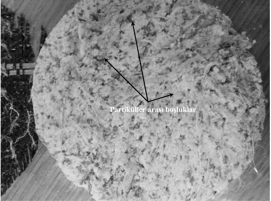
Şekil 11. Sıkıştırılmış siltli kum üzerinde kontrol örneklî yöntem (KÖY) ile 62 gün hidrasyon sonunda GKÖ'de açığa çıkarılan bentonitin durumu
