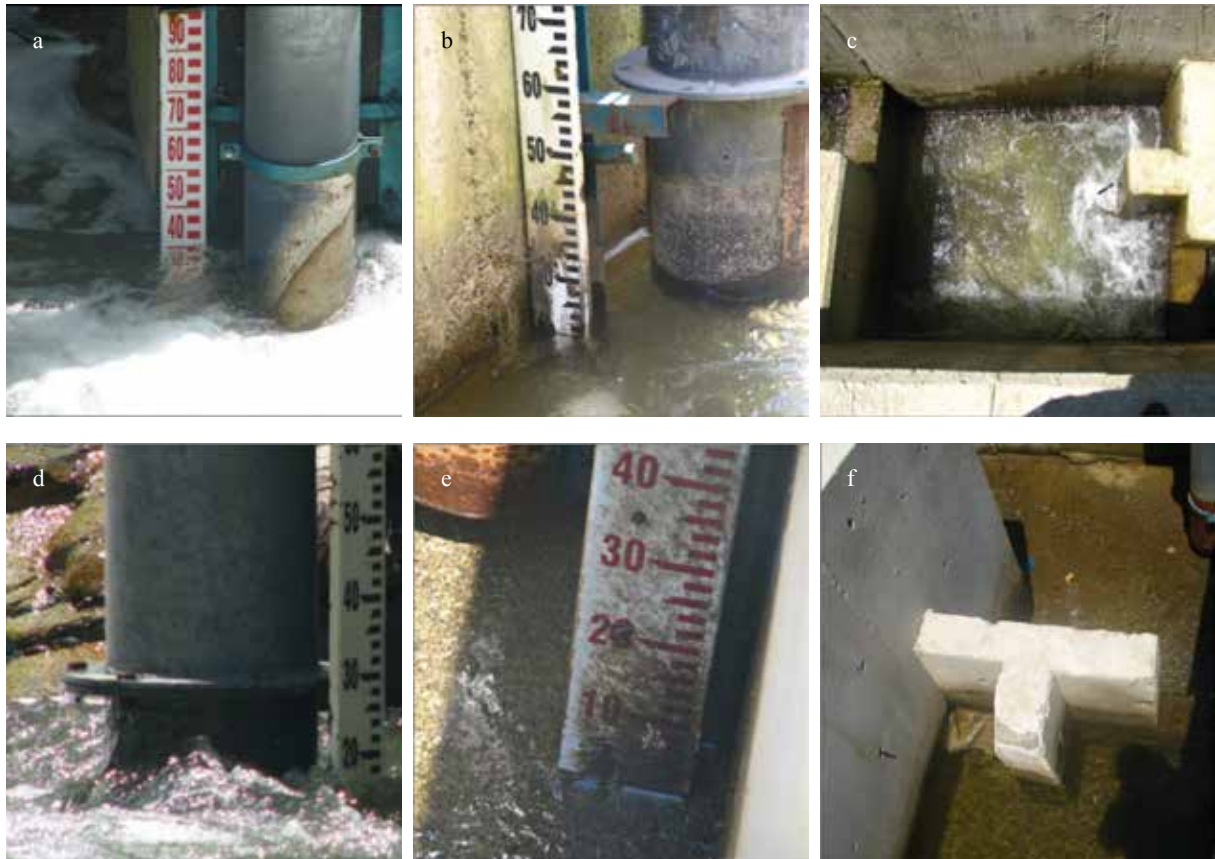
Şekil 19. a-f. Trabzon, Maçka, Maden Deresi üzerinde faaliyet gösteren bir regülatörün giriş ve çıkışlarındaki akımları ölçen AGİ cihazlarına ait ardışık süreçlerdeki su seviyeleri. Yaklaşık bir haftalık süreçte giriş ve çıkış akımları ile balık geçidi havuzundaki su seviyesinde çok radikal bir azalma gözlenmiştir. 16 Haziran, 2012: (a) memba (b) mansap (c) balık geçidi/havuzu, 16 Haziran, 2012: (d) memba, (e) mansap, (f) balık geçidi/havuzu.
