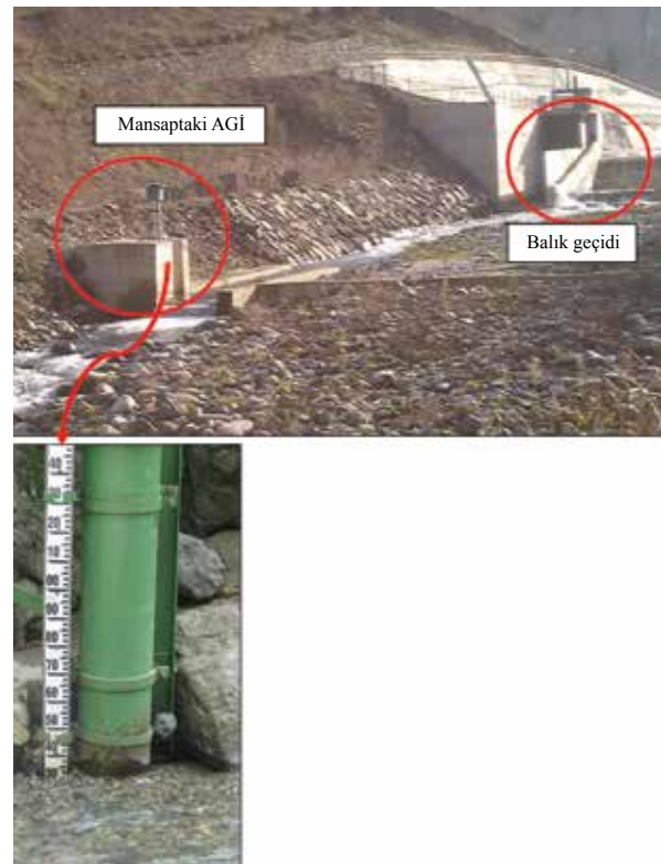
Şekil 4. a, b. Optik okuyuculu akım gözlem istasyonu (AGİ): Regülâtörden verilen telafi suyunu ölçmektedir (a) genel, (b) detay.
