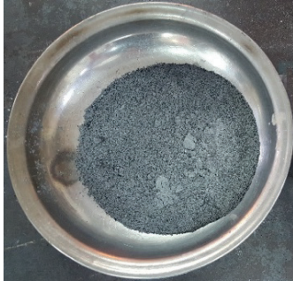
Şekil 1. Seramik fırınında yakılarak elde edilen odun külleri.
