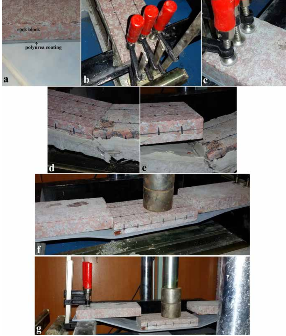
Şekil 12.a) Poliüre kaplama, b ve c) beton ve polimer kaplamalı blokların mesnetlenmesi, d) çatlamış beton kaplama, e) beton yapışma yüzeyindeki ayrılma, f) poliüre yapışma yüzeyi tarafından taşınan orta blok, g) poliüre yapışma yüzeyinde tamamen ayrılma
