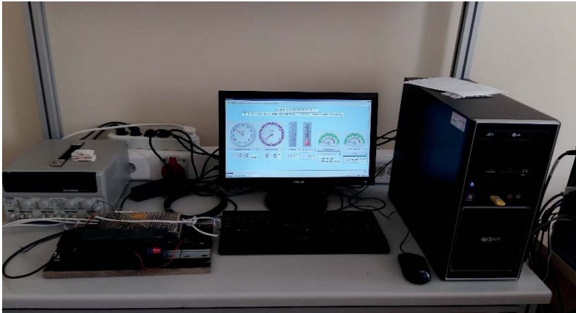
Şekil 3. PLC tabanlı meteoroloji SCADA sisteminin genel bir görünümü
