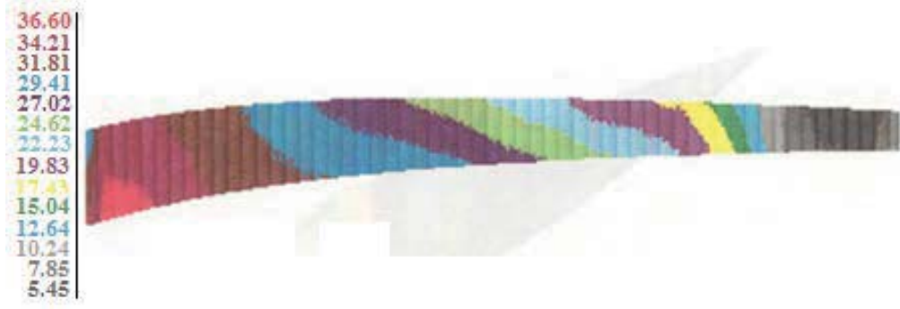
Şekil 11. Rüzgar türbin kanadının ikinci ara destek elemanındaki gerilmeler (MPa)
