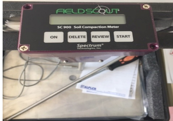
Şekil 1. Denemelerde kullanılan dijital penetrometre
