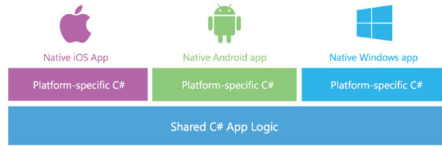
Şekil 5: Cross platform yapısı [11].
