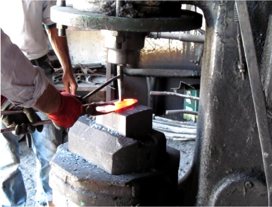
Fotoğraf 22. Sap Boşluğunun Açılması İçin İlk Çentiğin Uygulanması
