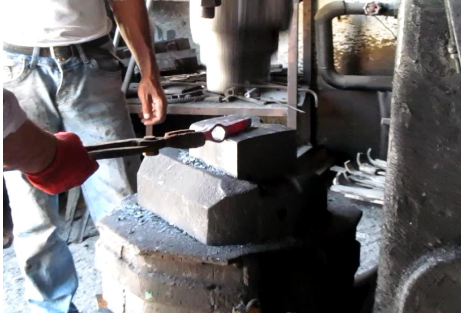
Fotoğraf 24. Oluşan Kazmanın Son Olarak Dövülerek Şekillendirilmesi
