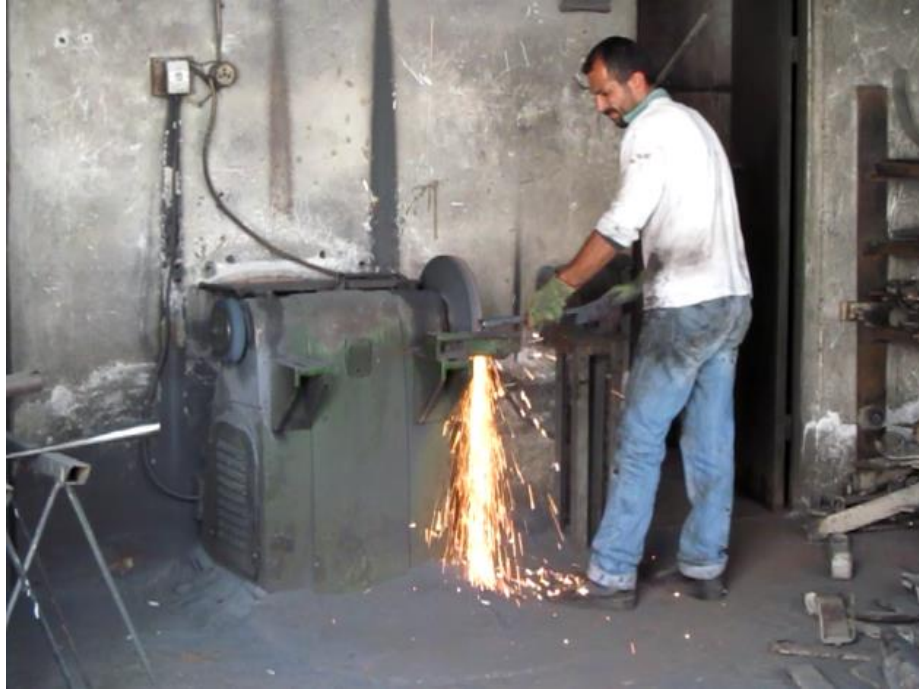
Fotoğraf 20. Yapımı Biten Dehrenin Keskinleştirilmesi ve Parlatılması
