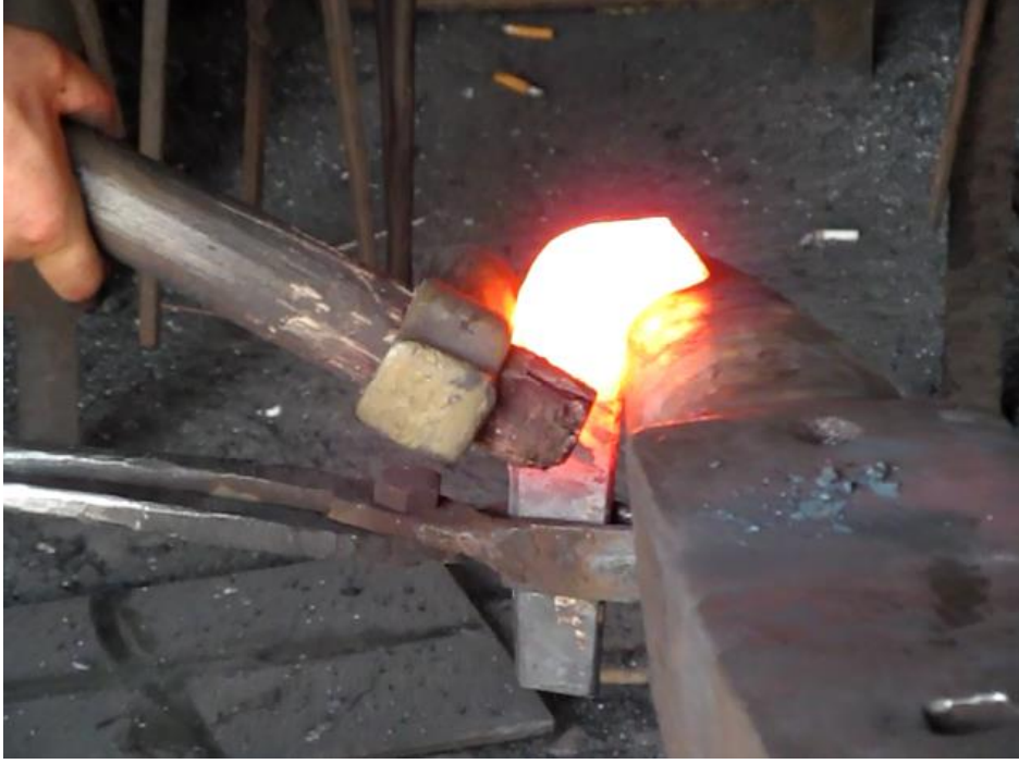
Fotoğraf 15. Dehrenin Baş Kısımının Örsün Ucunda Şekillendirilmesi
