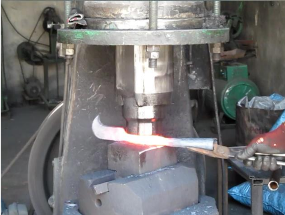
Fotoğraf 18. Dehrenin Boyun Kısımının Oluşturulması
