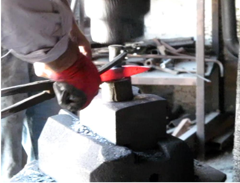
Fotoğraf 23. Silindir Kalıplar Yardımıyla Sapın Gireceği Boşluğun Açılması
