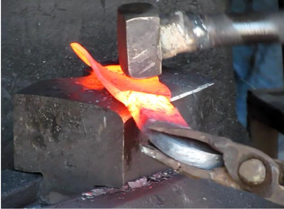
Fotoğraf 16. Dehrenin Sap Kısımının Şekillendirilmesi
