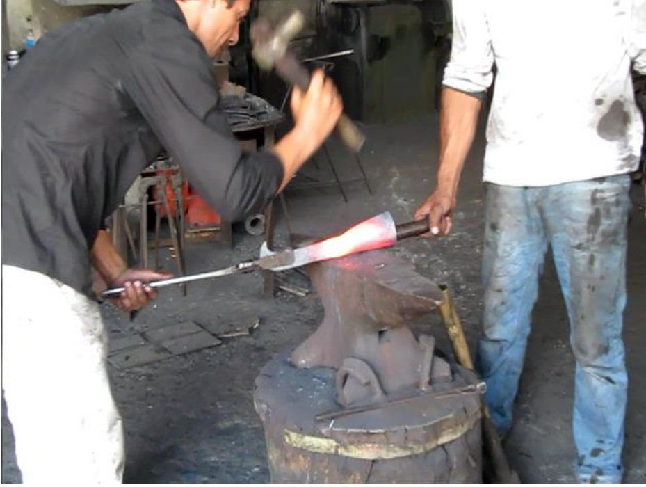
Fotoğraf 17. Dehrenin Sap Kısımının Kalıba Oturtulması
