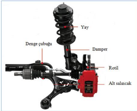
Şekil 2. MacPherson süspansiyon (MacPherson suspension)
