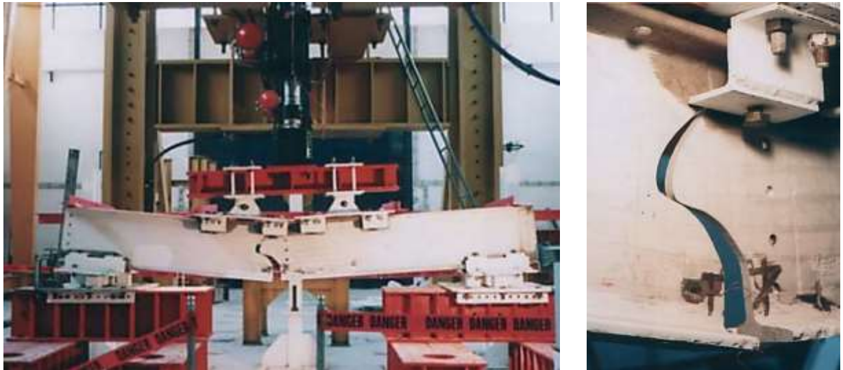
Şekil. 12. Test düzeneği ve yorulma çatlığı
