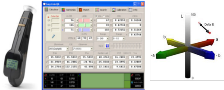
Şekil 1. CEI L*A*B* Renk Sistemi ve Çalışmada Kullanılan Dijital Renk Ölçer (Kromametre)
